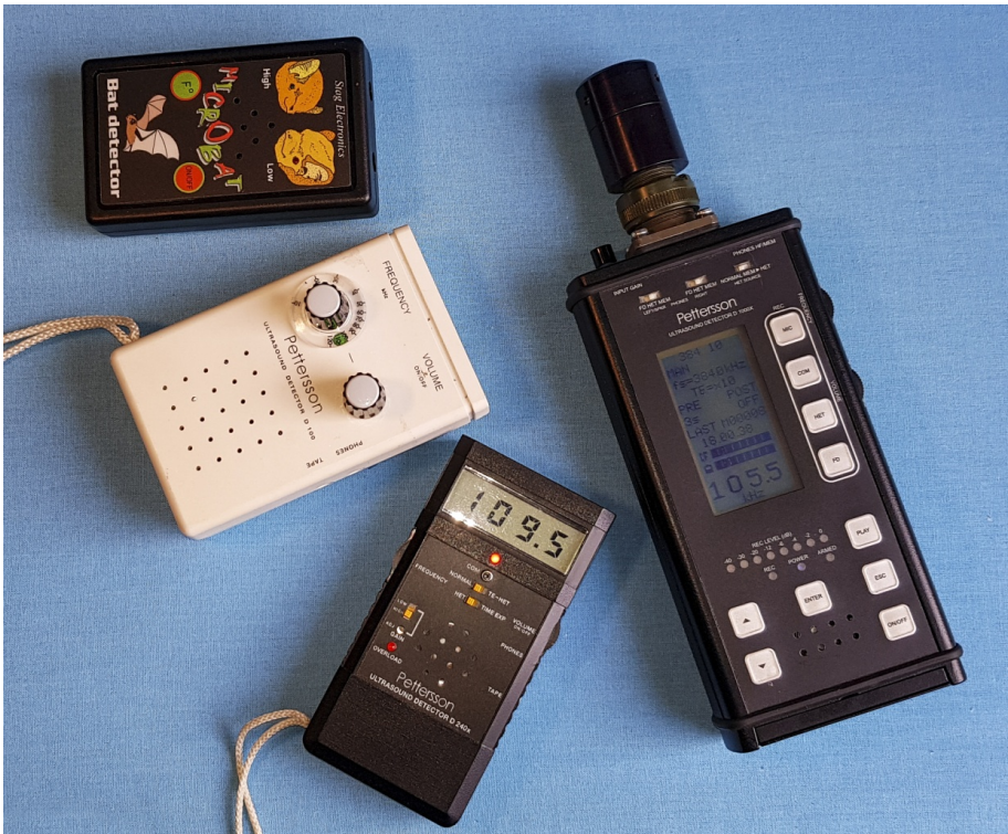
Fot. 2. Różne typy detektorów ultrasonicznych. W lewym górnym rogu detektor dla dzieci, potem (od lewej) prosty detektor heterodynowy, detektor heterodynowy z systemem Time Expansion i funkcją pozwalającą na przesłuchiwaniu zarejestrowanego materiału (do ok. 3 sekund) w trybie heterodyny – (bardzo przydatna właściwość) oraz profesjonalny detektor z bardzo czułym mikrofonem, umożliwiając nagrywanie na karcie pamięci sygnałów nietoperzy w pełnej rozdzielczości.
